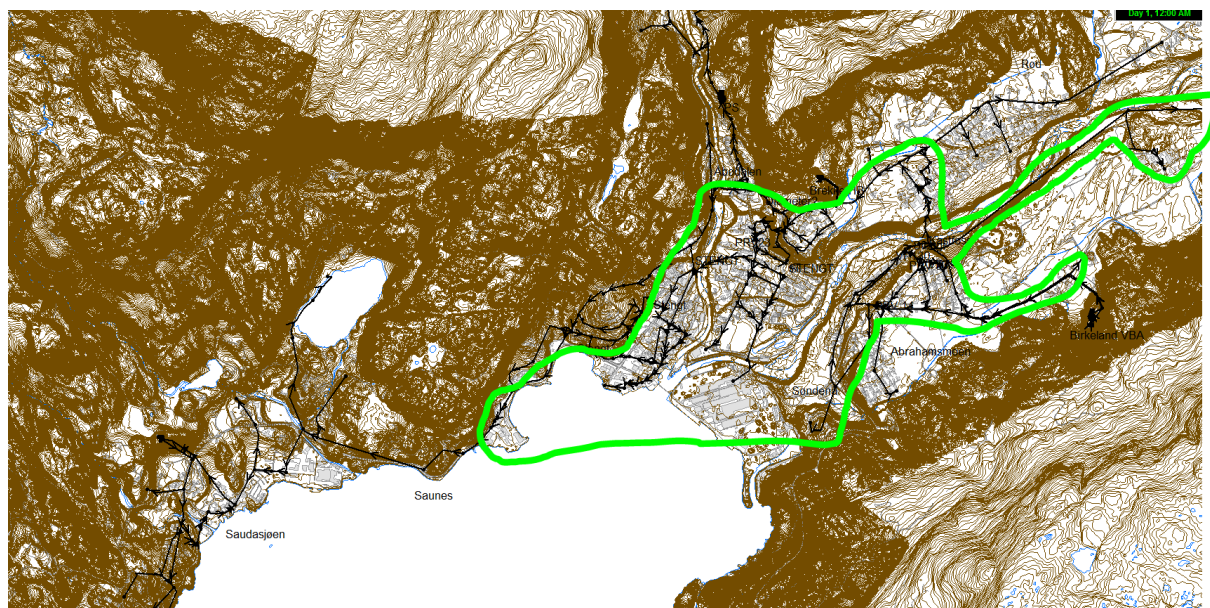
Figur under: Omtrentlig område med brannvannskapasitet 50 l/s og 1 bar trykk
